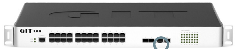
Магистральные оптические порты поддерживают широкую линейку SFP модулей
